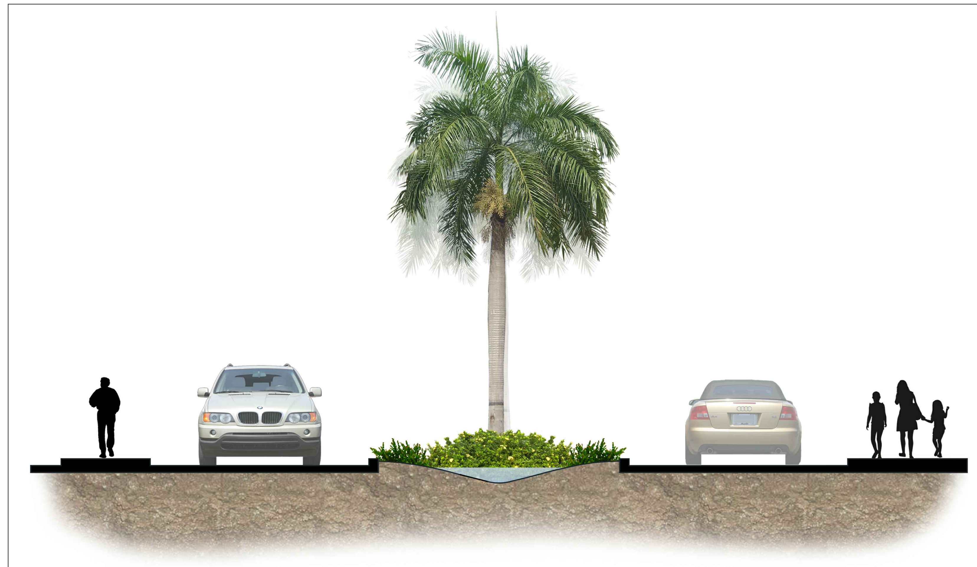
DEPRESSED RAIN GARDEN 2 2 SCALE: N.T.S. LA 105
