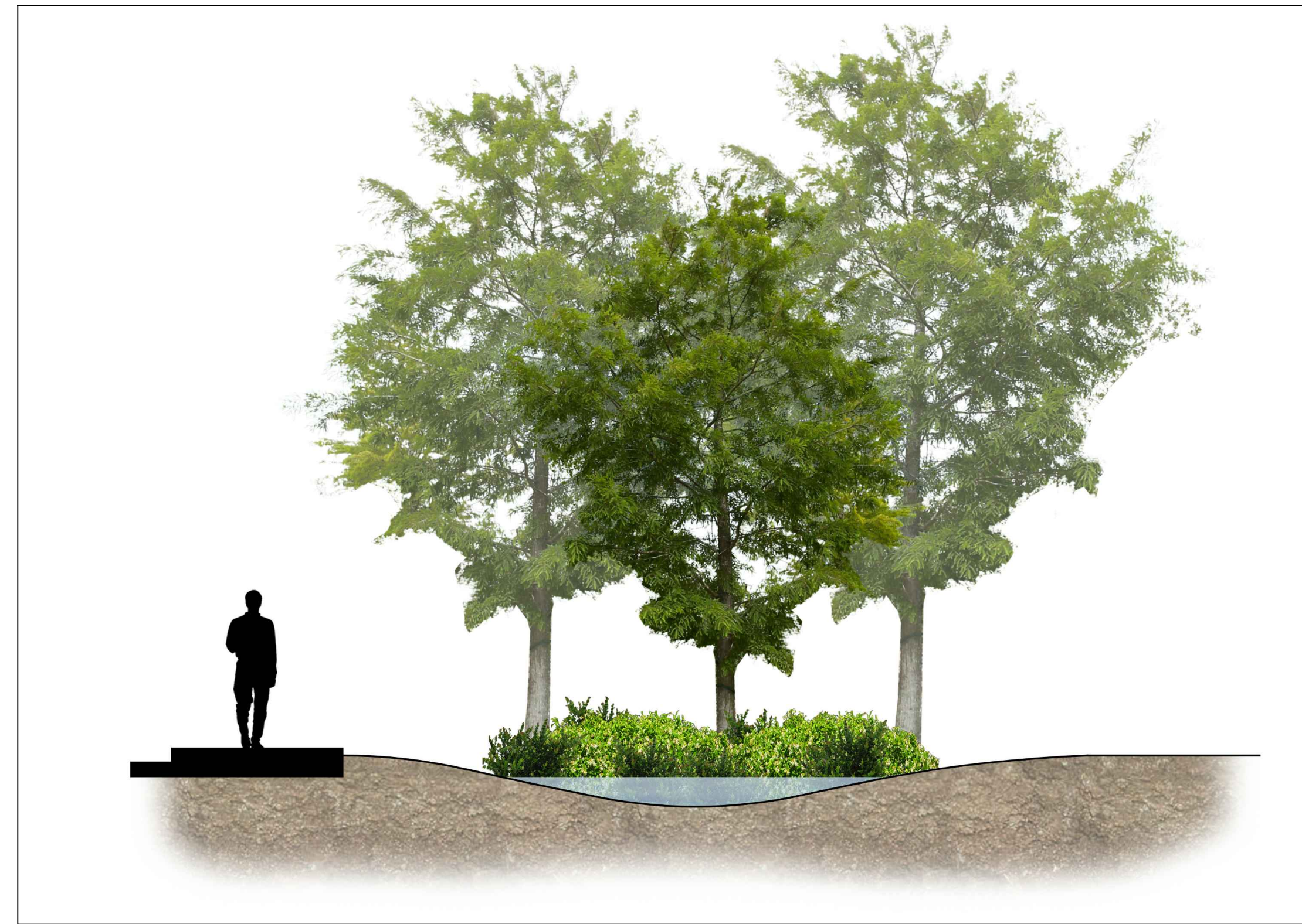
DEPRESSED RAIN GARDEN 1 1 SCALE: N.T.S. LA 105
